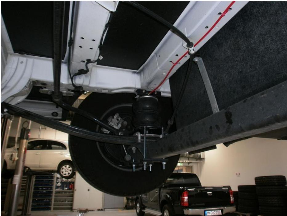
Bild 5: Zusatzluftfeder Einbausituation (Montagesatz DR.02.012428)
