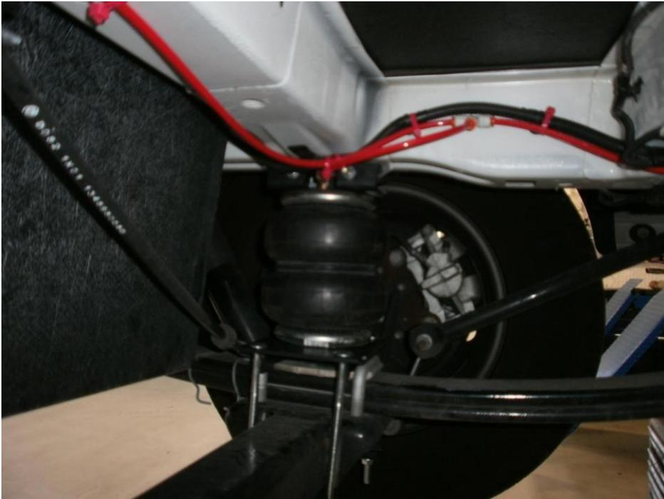
Bild 3: Zusatzluftfeder Einbausituation (Montagesatz DR.02.012428)
