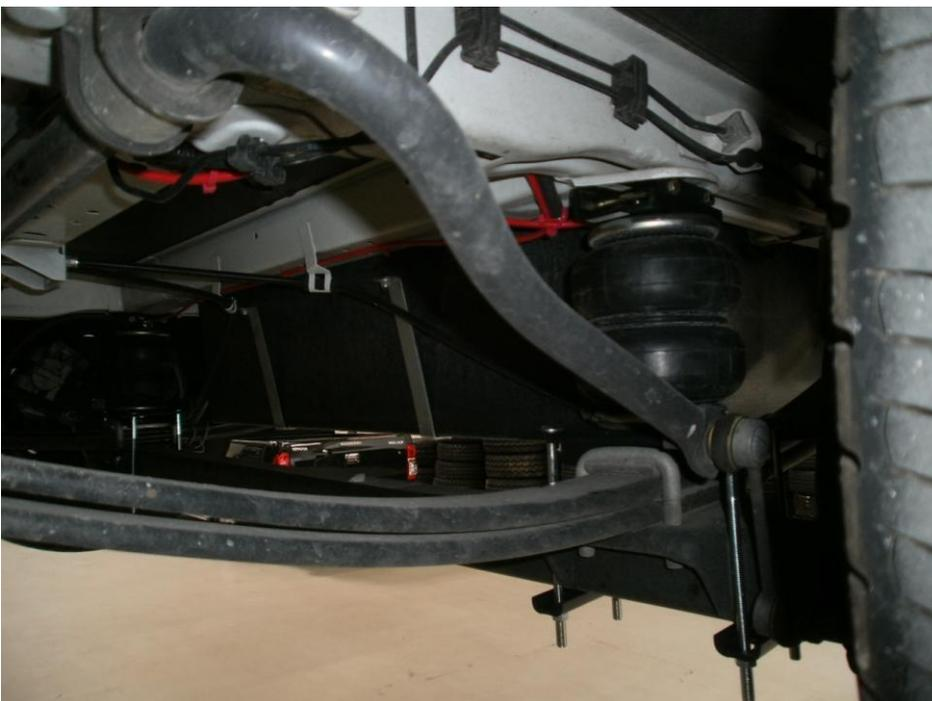
Bild 4: Zusatzluftfeder Einbausituation (Montagesatz DR.02.012428)
